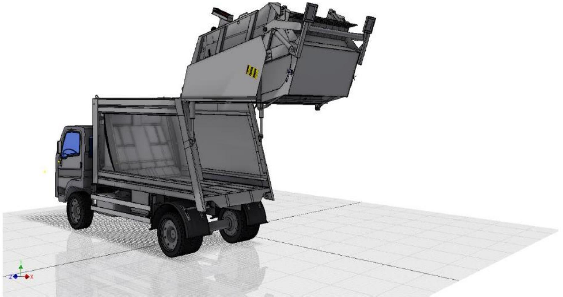
La basura dentro de la caja se descarga mediante la placa eyectora condensadora -
