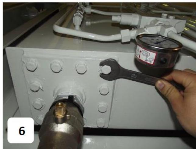
5-Filtro limpiado se instala al tanque de aceite como se indica en la figura.
