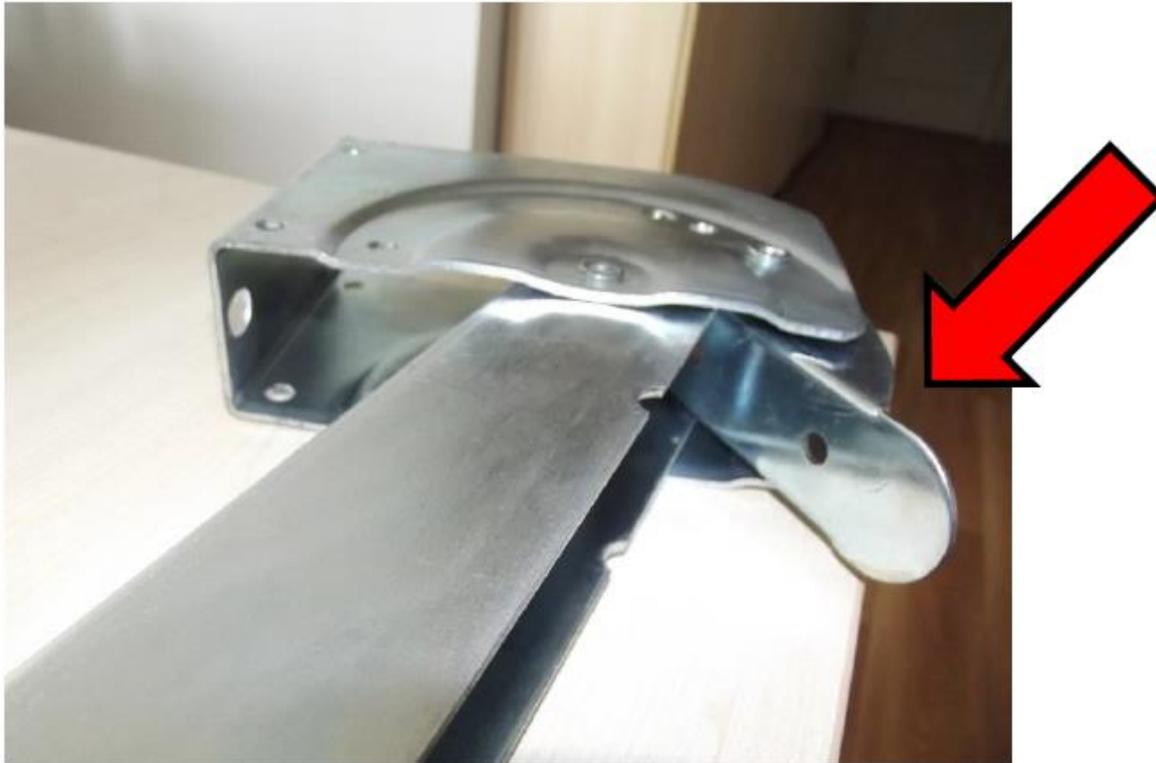
Para cerrar la barrera ,pasador de seguridad ,que se indica con la flecha en la figura ,se mueve en la dirección de la flecha y desbloqueado y la barrera se vuelve a su primera posición cerrando hacia abajo.
