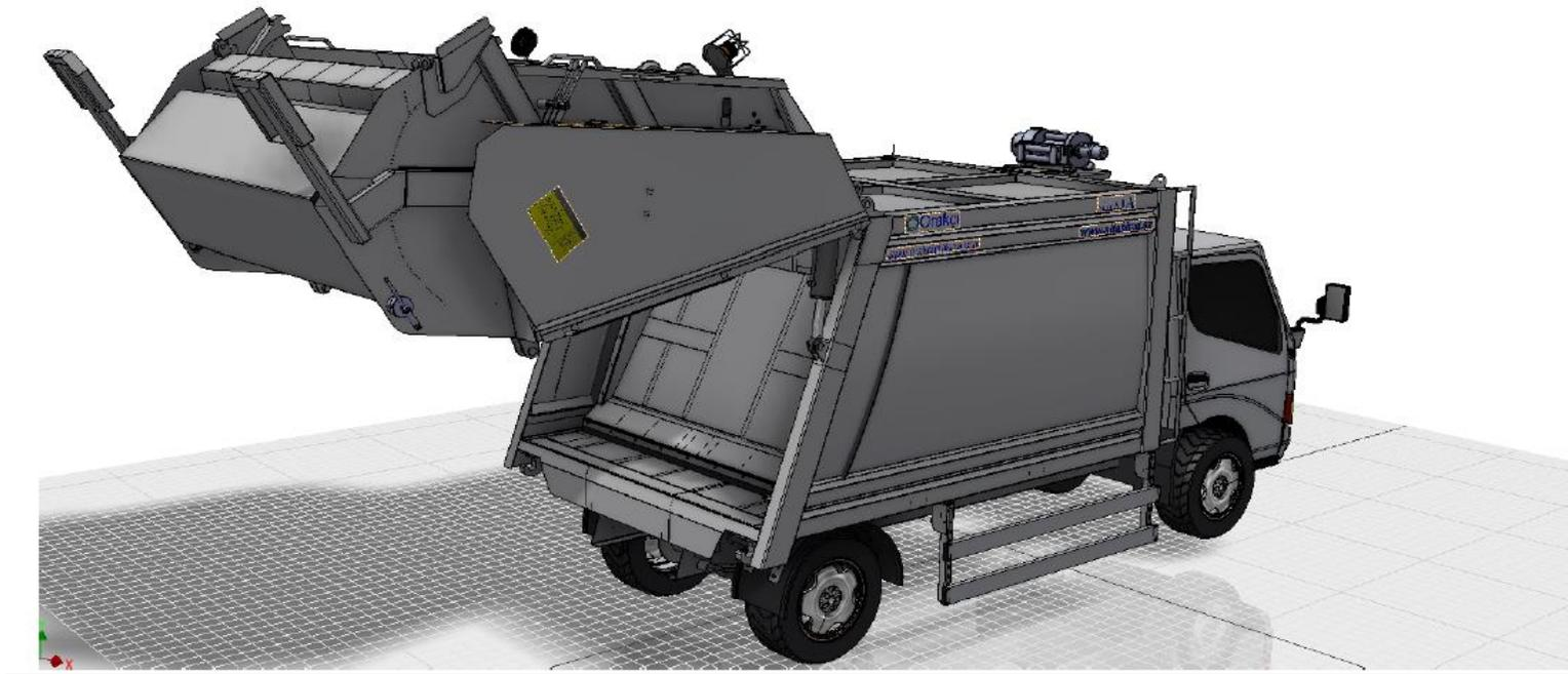
La compuerta trasera se abre al mantener barra de mando en la dirección de la flecha como se representa como se representa con una línea recta como se muestra en la figura ,o vice versa
