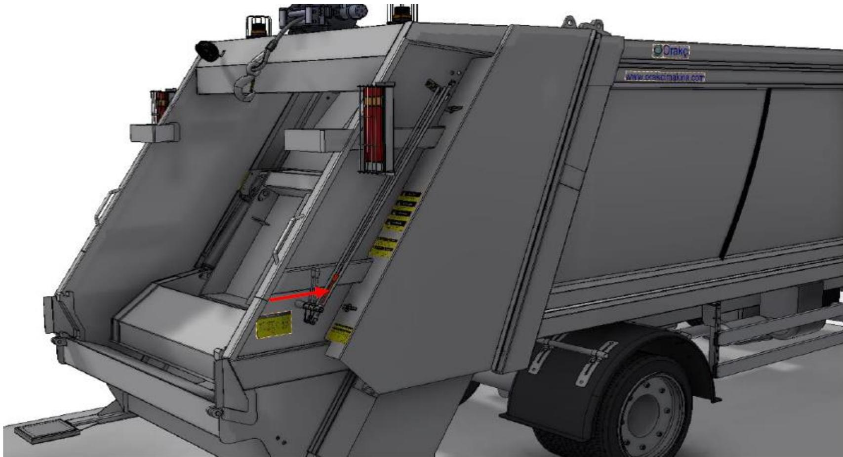
Gancho de cable se moverá hacia arriba mientras la palanca se mantenga en la dirección de flecha como indicado de arriba.
