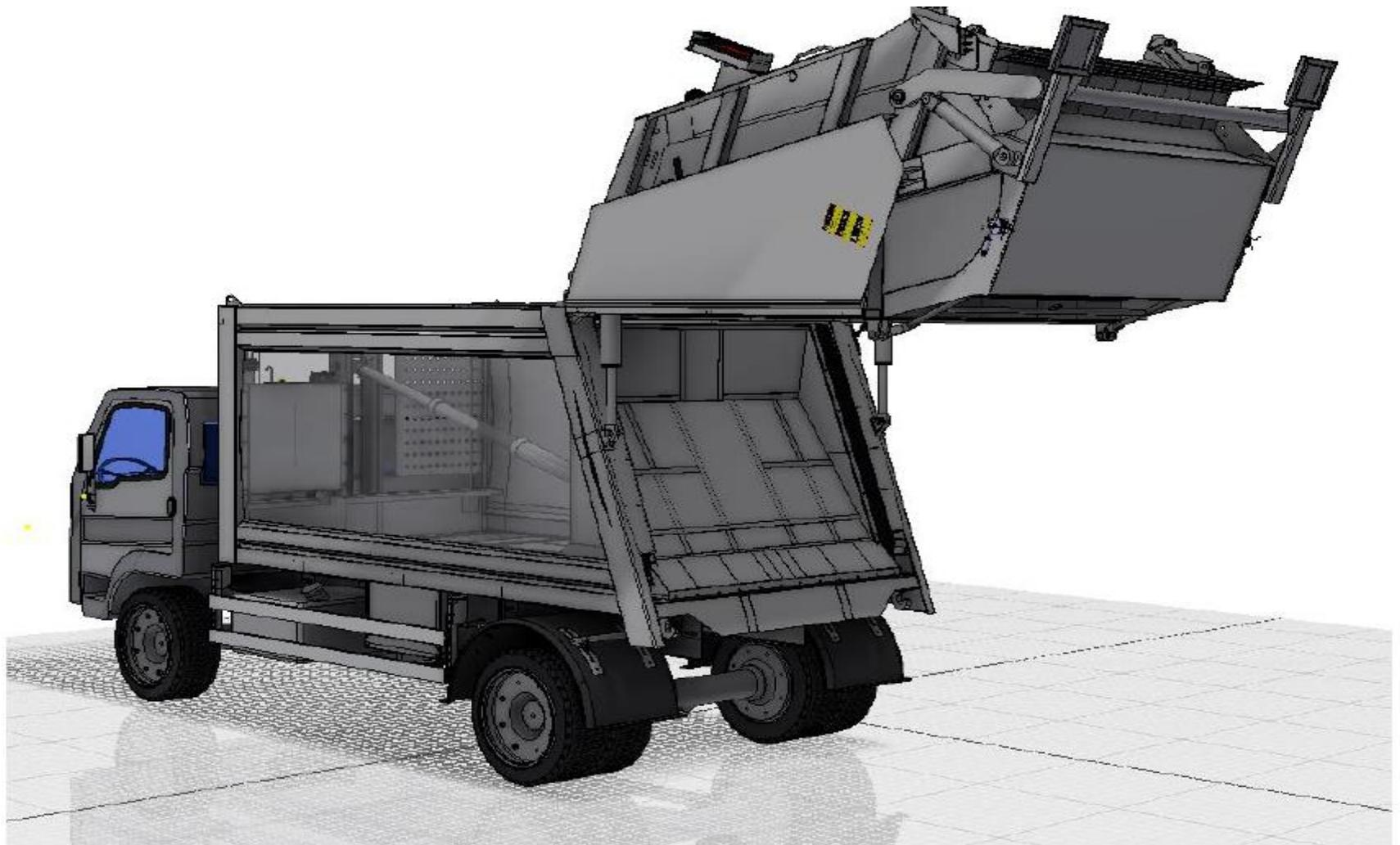
Descarga la basura por accionar la placa eyectora hacia adelante.
