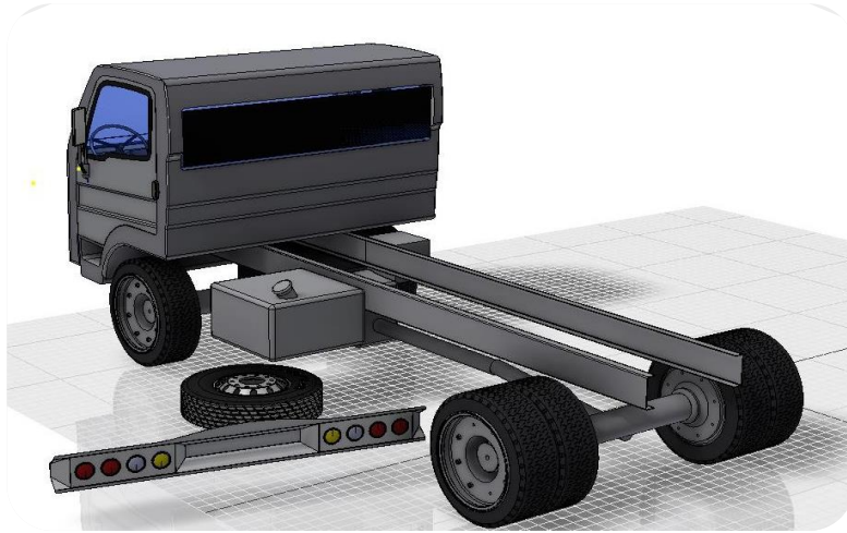
Figura 9: Desmontaje del Tampón Trasero para el Montaje
