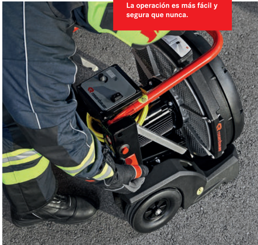
Los modelos E y V pueden llevarse a la posición de ataque inicial (+20°) mediante un mango.
