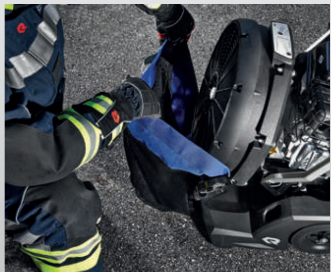
Montar la red de espuma en la unidad del ventilador.
